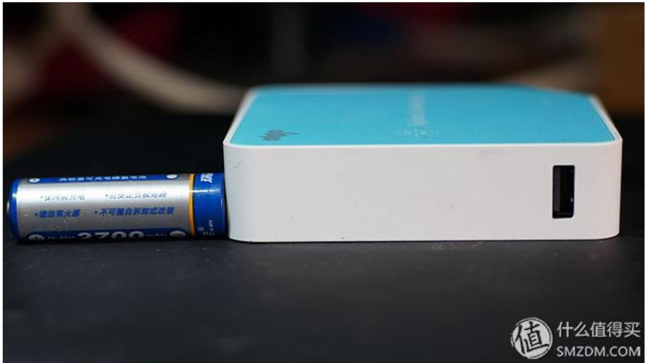
虽然整个电源呈正方形，但是右下角故意塌陷了一小块，作为开关，也算方便操作了。开关一旁四个小孔，电源容量知识，老规矩，全亮满电，一个孔代表25%电量。给手机充电时，按下开关，指示灯先全亮，再指示实际电量。随后充电。如果10秒没有检测到充电手机的话，自动关闭，还算人性化。蓝色面板有轻微磨砂感，做工还算工整，没有高低不平的地方--除了下图中大家仔细观察发现开关和水平线部分有细微不平，处女座的强迫症患者会不爽的，其余还没有发现不满意的。
